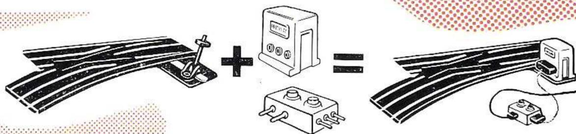
C'est vraiment très facile d'amener vos clients à transformer leurs aiguillages 810/811 en aiguillages télécommandés. Deux vis à enlever et à remettre, et c'est tout. Et le prix des commandes à distance permet vraiment de parvenir à la télécommande, en deux étapes, à de très bonnes conditions.
