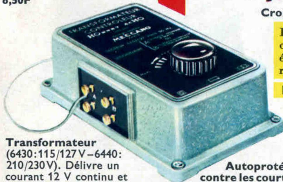
**Transformateur** (6430: 115/127V - 6440: 210/230V). Délivre un courant 12 V continu et un courant pour éclairage et télécommande 15 V alternatif.
