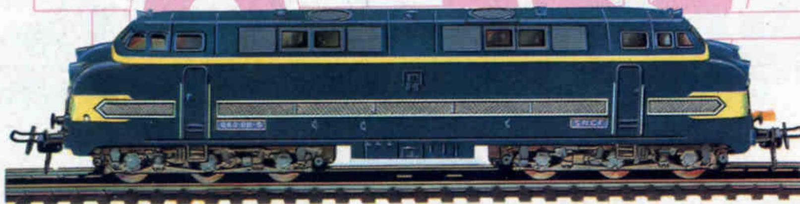
**6340** - Reproduction de la locomotive Diesel 060 DB. Poids 104 t. Longueur hors-tout 19,814 m. Puissance nominale 1 800 cv. Vitesse en service 130 km/h. Cette locomotive est plus particulièrement affectée à la région du Sud-Ouest. Son dépôt est à La Rochelle. Notre modèle, avec éclairage, mesure 240 mm.
