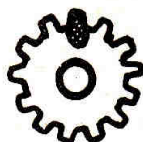
Figure 4. — Le trait de repère à tracer à la craie est placé à la partie supérieure de chaque engrenage, à la verticale de son axe.
