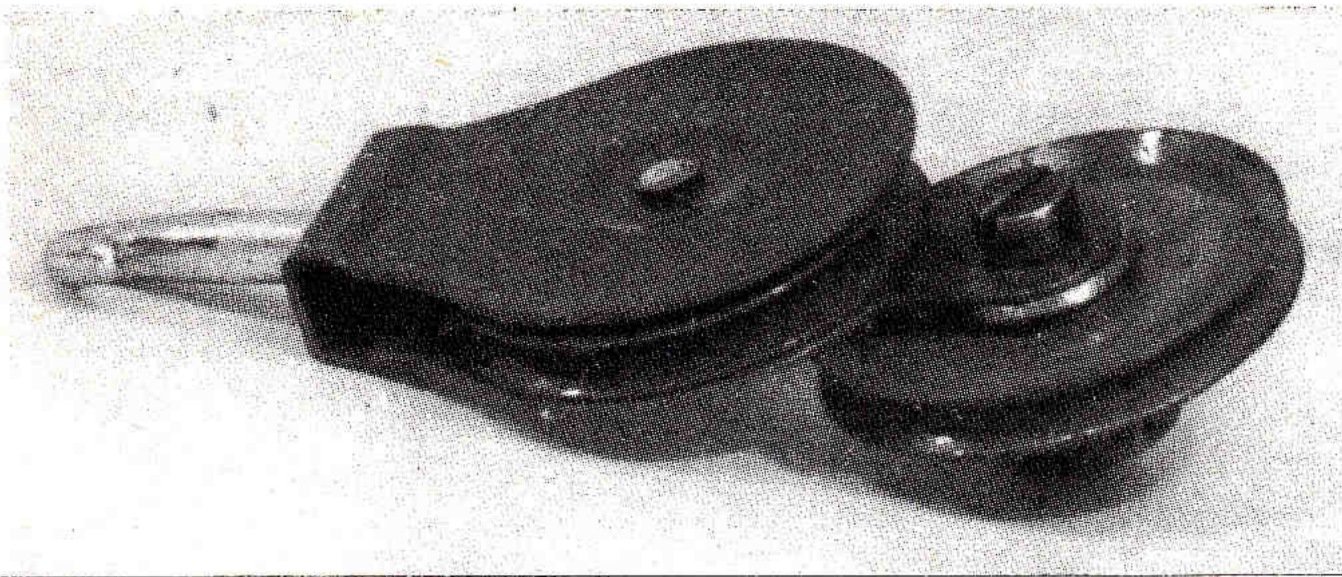
Figure 3. — Montage d'un palan à deux poulies. Une rondelle-disque est intercalée entre la tête de la vis et la poulie de 25 mm ajoutée.
