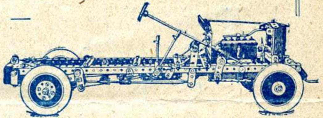
Chassis d'Auto, mécanisme complet, Démarreur, Arbre à cardan, Vitesses, Joint universel, Différentiel, etc..
