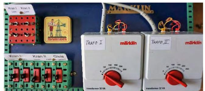
Das Stellpult unter der Brücke (sozusagen im Tal der Wupper) mit zwei Trafos und den Schaltern für die Krane I und II (jeweils Haken, Fahrt, Licht). Das Pult ist zum Transport als Ganzes mit Steckern abkoppelbar.
