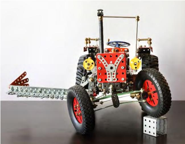
*Ansicht von vorne mit gelenkter und gefederter Vorderachse und Mähbalken in Arbeitsstellung*
