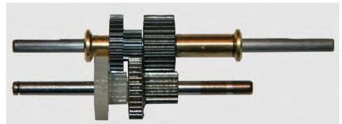
**Fig. 6: Zur Drehzahlerhöhung geändertes Getriebe.**
