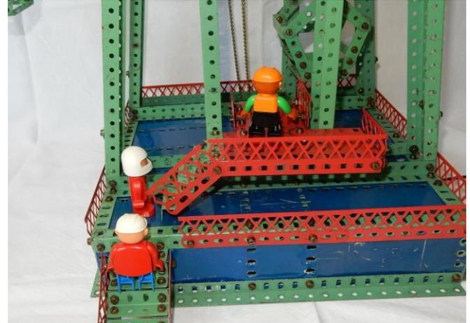
Den Motor, der als einziges kein Märklin-Originalteil ist, habe ich unter der Plattform montiert. Der Antrieb erfolgt über die Märklin-Kette.
