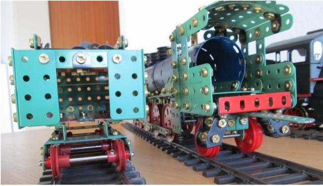
Der Lokrahmen (5 Loch breit) besteht aus Winkelträgern, an deren Unterseite drei 4-Loch-Verbindungs-bügel geschraubt sind. Darin laufen die Treibachsen. Vor- und Nachläufer sind beweglich gelagert. Das Führerhaus hat eine Breite von 6 Loch, der Tender von 7 Loch. Dessen größere Breite passt optisch, weil die Lok mit ihrem Rahmen und dem Gestänge seitlich auslädt.
