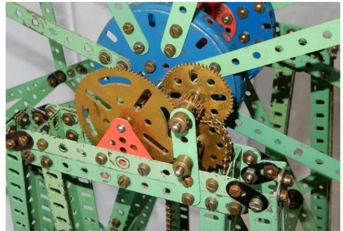
Das Getriebe hat aus zwei Gründen seinen Platz oben an der Welle gefunden: Die Zahnräder waren zu groß, um noch unter der Plattform genug Platz zu haben. Und die Kette läuft jetzt mit höherer Geschwindigkeit und damit mit geringer Kraft als wenn man sie nach dem Getriebe mit geringer Geschwindigkeit mit sehr hoher Kraft beaufschlagt.
