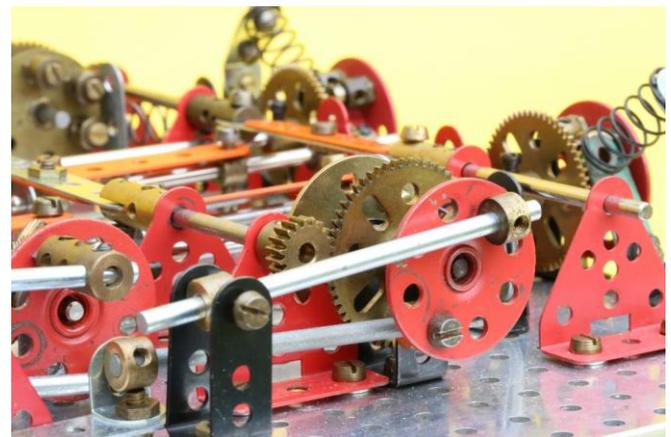
Auf den Wellen mit den Lochscheibenrädern sind noch weitere Lochscheibenräder oder Kurbeln. An diese weiteren Räder/Kurbeln sind jeweils zwei Achsen befestigt, die mit (Schalt-)Lochbändern verbunden sind und die Drehung zu orange oder grau bewirken (Translation=>Rotation).
