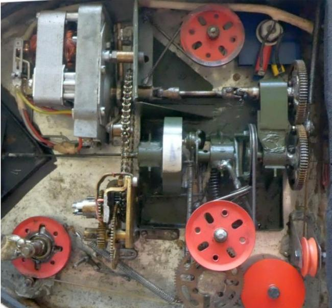
*Links oben der VW-Scheibenwischermotor mit einem Übertrieb mittels einer Märklin-Antriebskette und einem weiteren Antrieb über zwei Märklin-Kugelgelenke*
