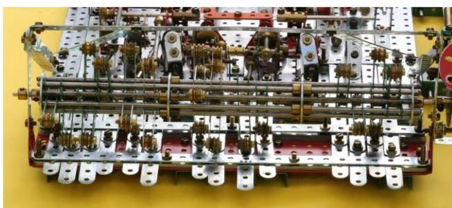
Die Lage am Umfang wird durch die zehn Achsen bestimmt. Die beiden Schnurlaufräder an den Nocken verschieben den Schraubenkopf mit den (Schalt-)Lochbändern. Die Lochstreifen verlangen Weg zum Verschieben, die Welle bietet jedoch nur Umfang an. Deshalb musste ich relativ lange Lochstreifen als „Nocken“ verwenden. Erste Versuche mit kürzeren Nocken schlugen fehl.
