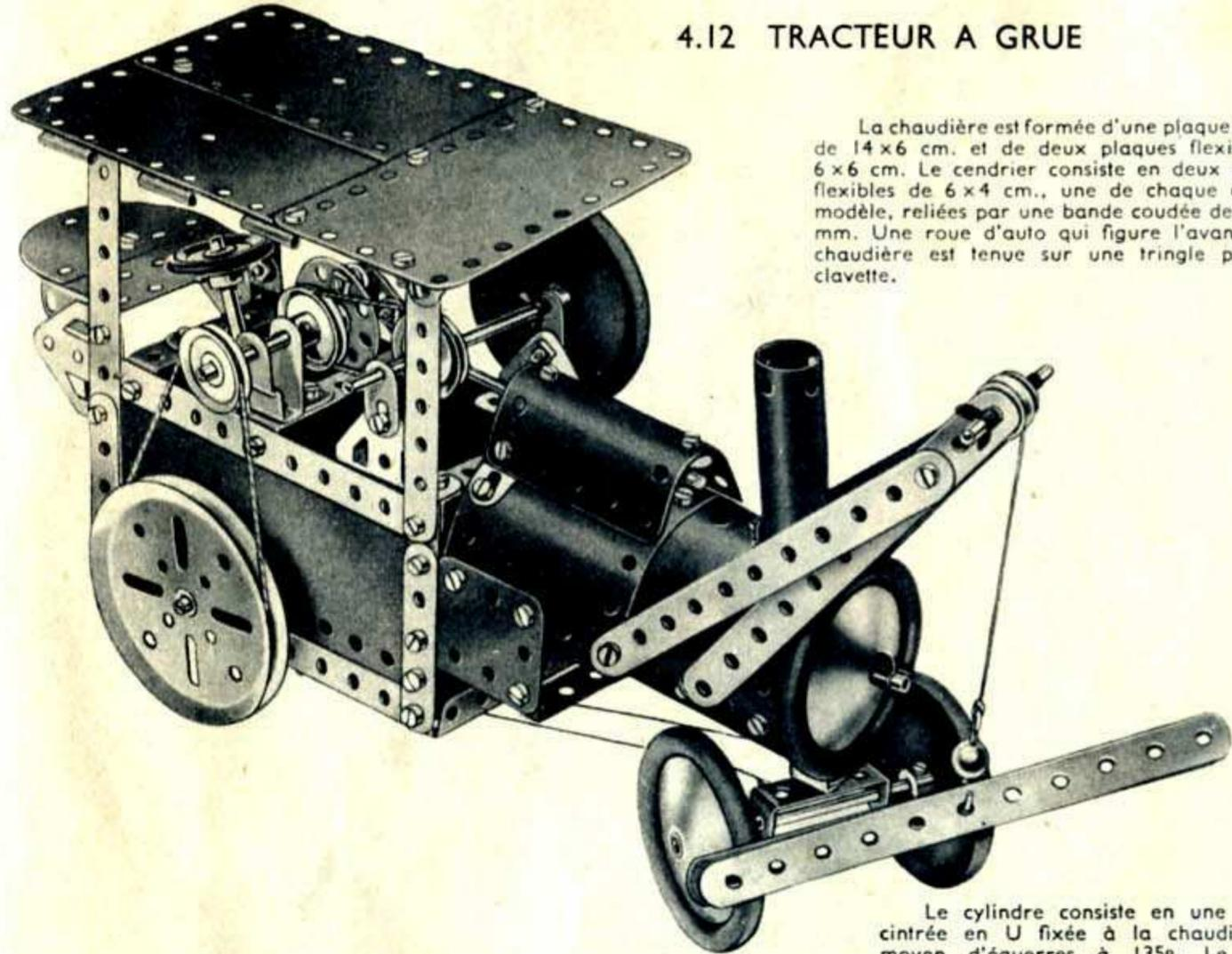
La chaudière est formée d'une plaque flexible de 14 x 6 cm. et de deux plaques flexibles de 6 x 6 cm. Le cendrier consiste en deux plaques flexibles de 6 x 4 cm., une de chaque côté du modèle, reliées par une bande coudée de 60 x 12 mm. Une roue d'auto qui figure l'avant de la chaudière est tenue sur une tringle par une clavette.
