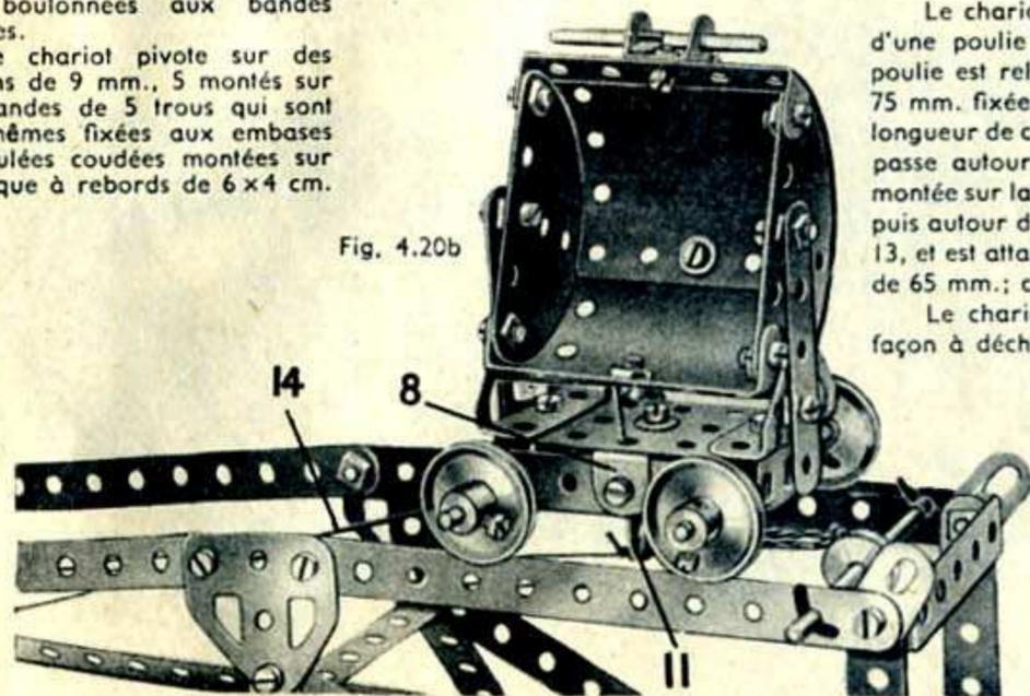
Le chariot est mû par une manivelle munie d'une poulie de 25 mm. 9 (Fig. 4.20a). Cette poulie est reliée par une corde à une poulie de 75 mm. fixée sur une tringle de 10 cm. 10. Une longueur de corde fixée à la chape 11 (Fig. 4.20b), passe autour d'une seconde poulie de 75 mm. montée sur la tringle 10, ensuite sous la tringle 12, puis autour d'une poulie de 12 mm. sur la tringle 13, et est attachée à une courroie de transmission de 65 mm.; cette courroie est fixée sur la chape.
