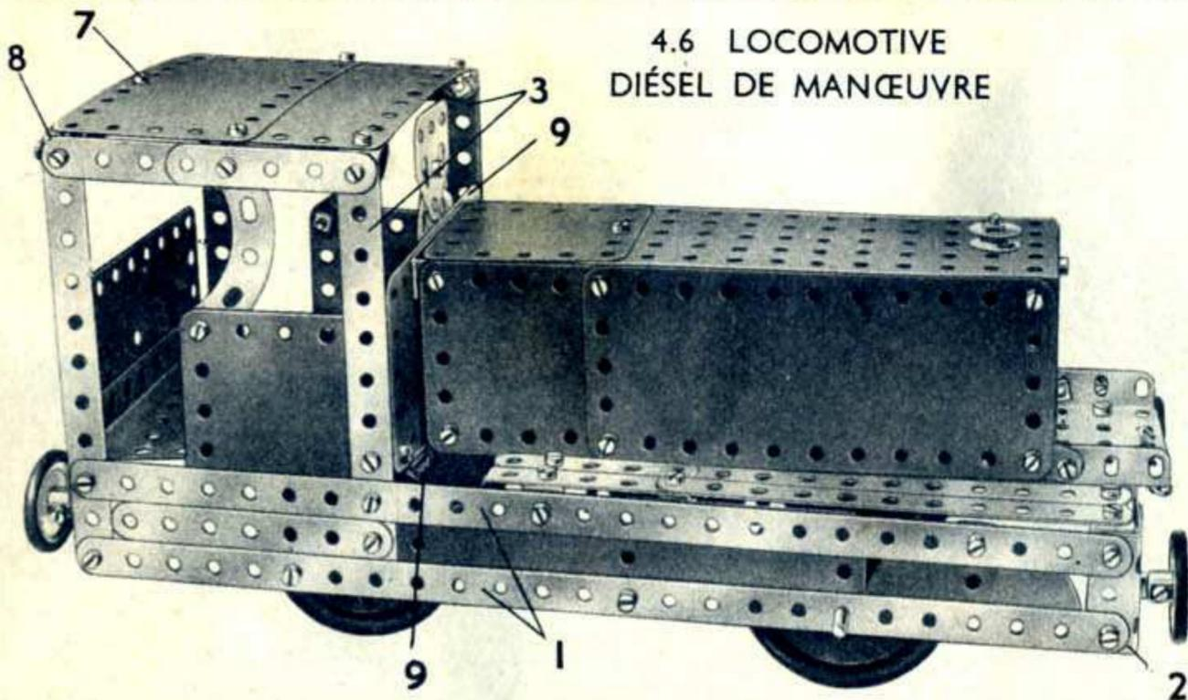
Les principales parties de la locomotive sont formées de bandes de 25 trous 1 boulonnées à une plaque flexible de 14 x 4 cm., une plaque semi-circulaire et les embases triangulées coudées 2. L'arrière de la cabine est formé par la moitié d'une plaque à charnière fixée au châssis par des équerres, l'autre moitié de la plaque à charnière est utilisée pour le devant de la cabine et est fixée à des bandes de 11 trous 3 par des équerres.
