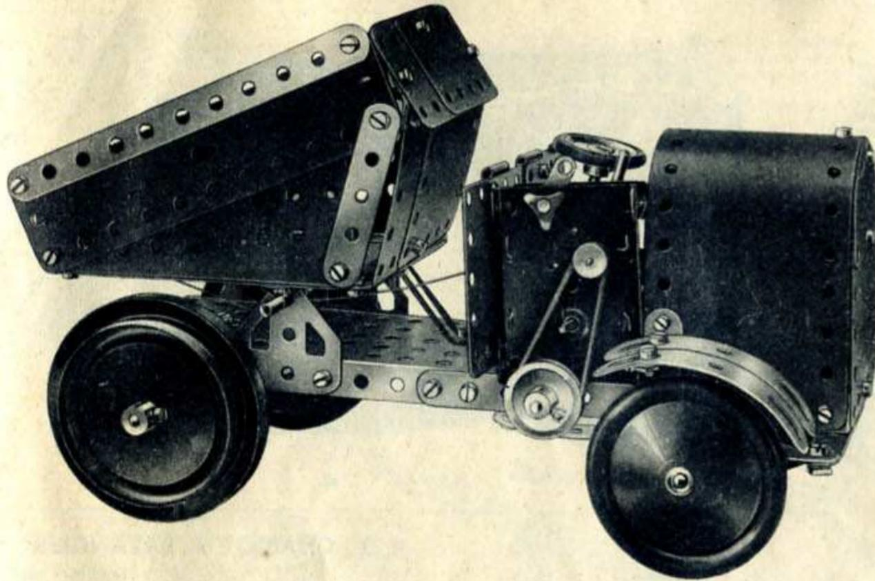
Une bande de 7 trous 3 (Fig. 4.24a) est boulonnée à une bande coudée elle-même fixée sur les bandes 1. Les bandes de 5 trous 4 et les supports doubles 5 peuvent tourner librement sur des boulons de 9 mm. 5 fixés à la bande 3 par deux écrous. Les bandes 4 sont reliées ensemble par une bande de 7 trous tenue par contre-écrous. Deux roues d'auto sont bloquées sur des tringles de 4 cm. passées dans les supports doubles 5.
