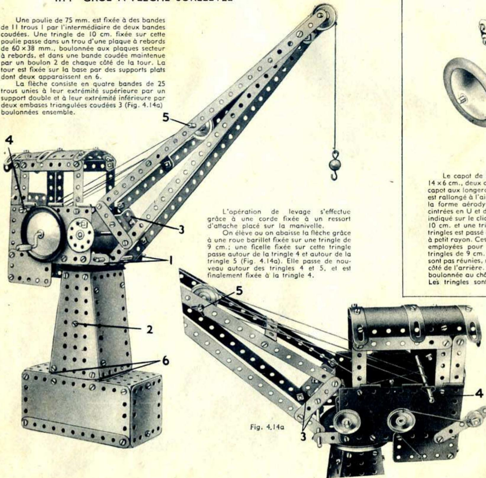
L'opération de levage s'effectue grâce à une corde fixée à un ressort d'attache placé sur la manivelle.
