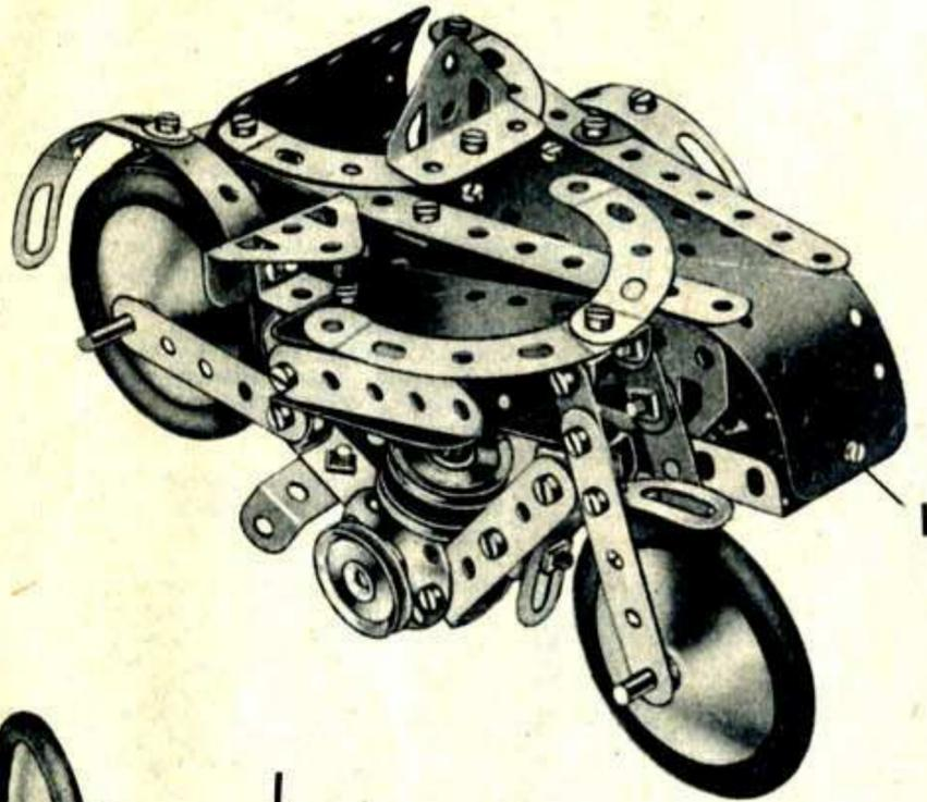
La plaque flexible de 14 x 4 cm. formant l'avant du sidecar est boulonnée en 1 à une bande coudée de 60 x 12 mm. fixée à l'aide du boulon 2 (Fig. 4.4a) à la plaque-secteur à rebords de 112 mm. constituant le fond du sidecar. Les boulons 3 passent à travers les plaques flexibles, ainsi qu'à travers une bande coudée de 60 x 12 mm.
