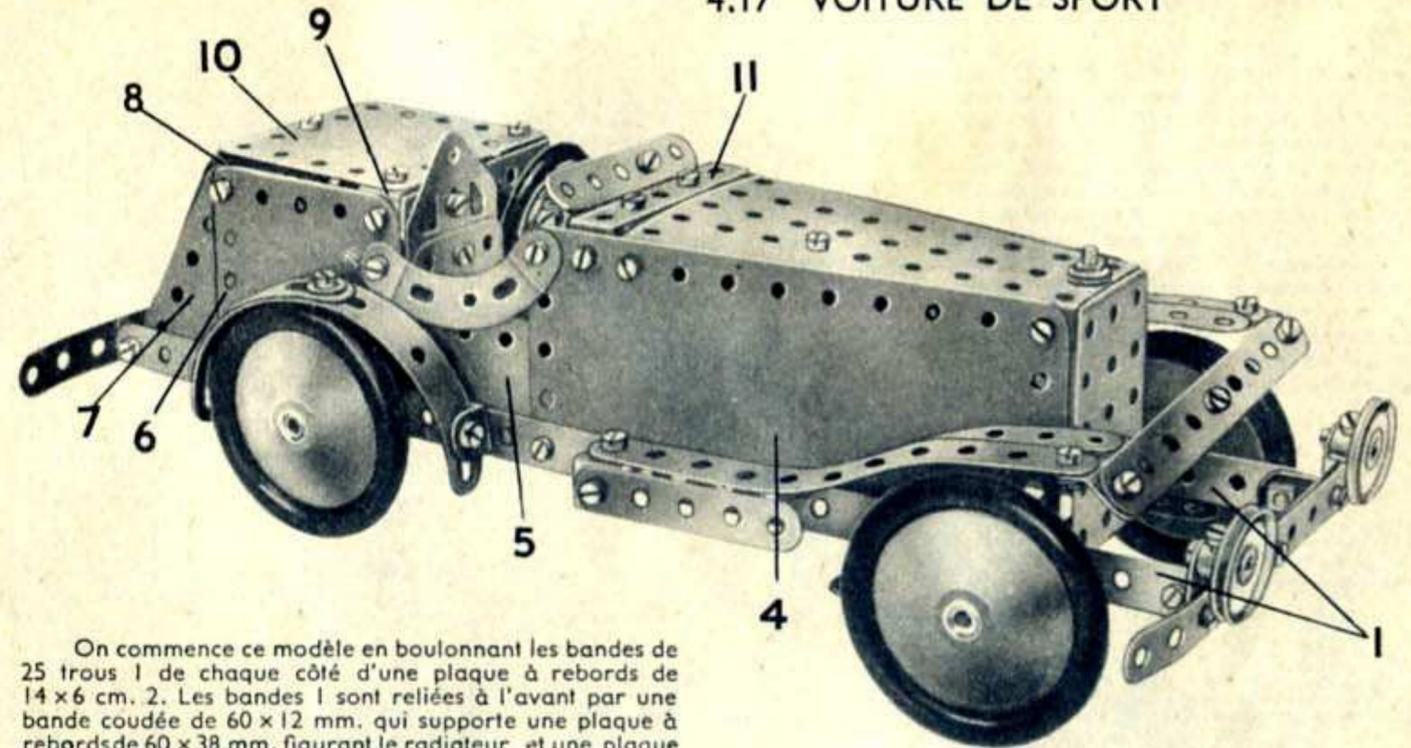
On commence ce modèle en boulonnant les bandes de 25 trous 1 de chaque côté d'une plaque à rebords de 14x6 cm. 2. Les bandes 1 sont reliées à l'avant par une bande coudée de 60x12 mm. qui supporte une plaque à rebords de 60x38 mm. figurant le radiateur et une plaque de 7 trous 3.
