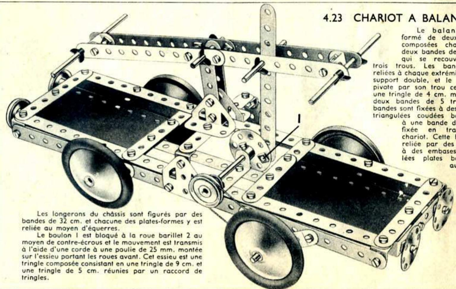
Le balancier est formé de deux bandes composées chacune de deux bandes de 11 trous qui se recouvrent sur trois trous. Les bandes sont reliées à chaque extrémité par un support double, et le balancier pivote par son trou central sur une tringle de 4 cm. montée sur deux bandes de 5 trous. Ces bandes sont fixées à des embases triangulées boulonnées à une bande de 7 trous fixée en travers du chariot. Cette bande est reliée par des équerres à des embases triangulées plates boulonnées au châssis.
