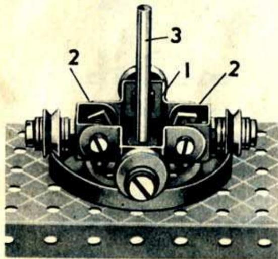
Le châssis est constitué par des cavaliers 1 reliés par deux supports doubles 2. Les quatre roues utilisées sont des poulies folles de 12 mm. qui tournent dans des boulons pivots fixés aux quatre extrémités du châssis. Quatre rondelles métalliques (2 de chaque côté des poulies) sont passées sur le corps de chaque boulon pivot fixé aux supports doubles 2. Pour les deux autres boulons pivots deux rondelles sont placées du côté extérieur de la poulie seulement.
