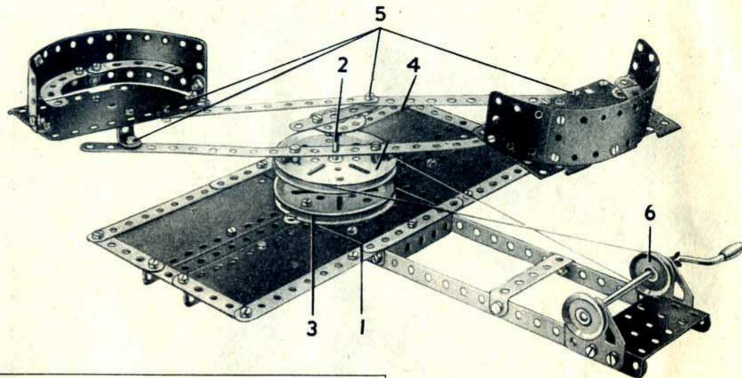
La base du modèle est formée par une plaque à rebords de 14 x 6 cm. 1 prolongée de chaque côté par une plaque secteur à rebords, une plaque flexible de 14 x 6 cm. et une autre de 11,5 x 6 cm. Les rebords de la base sont renforcés par des bandes perforées. Deux bandes de 25 trous sont boulonnées aux rebords de la plaque 1 et leurs extrémités sont reliées par une plaque à rebords de 60 x 38 mm.; deux embases triangulées plates servent de supports à la petite manivelle.
