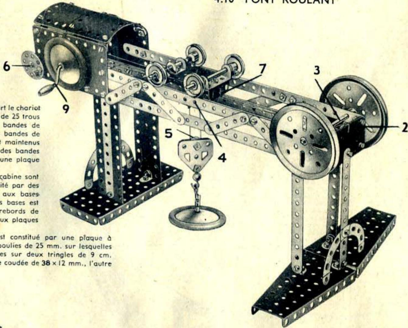
dans un support double. Le boulon 1 (Fig. 4.10a) fixe la chape 4 à la face inférieure de la plaque à rebords 7. Une tringle de 25 mm. traverse les trous inférieurs de la chape et y est tenue à l'aide de clavettes.
