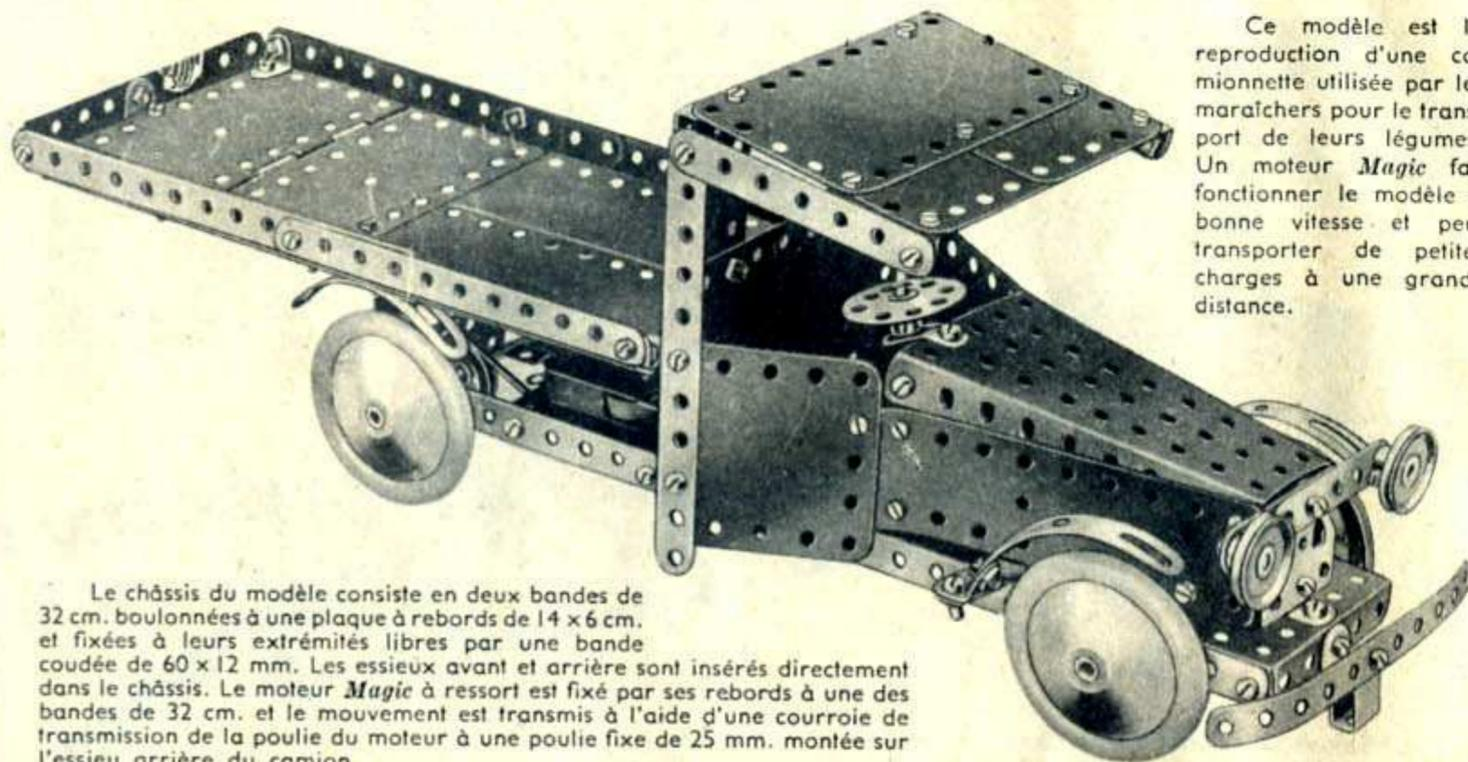
Le châssis du modèle consiste en deux bandes de 32 cm. boulonnées à une plaque à rebords de 14 x 6 cm. et fixées à leurs extrémités libres par une bande coudée de 60 x 12 mm. Les essieux avant et arrière sont insérés directement dans le châssis. Le moteur *Magic* à ressort est fixé par ses rebords à une des bandes de 32 cm. et le mouvement est transmis à l'aide d'une courroie de transmission de la poulie du moteur à une poulie fixe de 25 mm. montée sur l'essieu arrière du camion.
