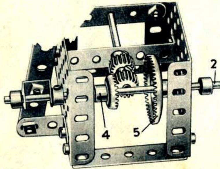
Ce mécanisme est destiné à donner une marche avant lente et une marche arrière rapide — ou vice-versa — et chacune des tringles peut être employée comme arbre moteur.
