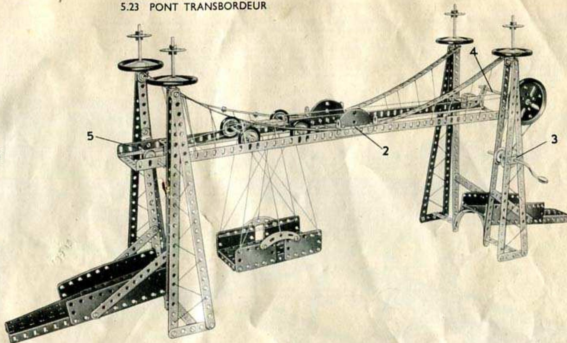
Deux des quatre tours pylons sont faites de trois bandes de 25 trous réunies au sommet par un support double; les deux autres tours sont construites de la même façon, mais deux des bandes utilisées sont faites d'une bande de 5 trous et de deux bandes de 11 trous.
