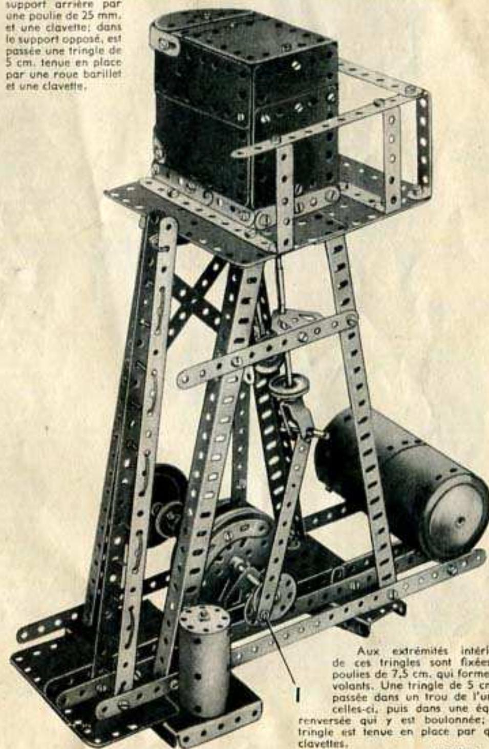
Aux extrémités intérieures de ces tringles sont fixées des poulies de 7,5 cm. qui forment les volants. Une tringle de 5 cm. est passée dans un trou de l'une de celles-ci, puis dans une équerre renversée qui y est boulonnée; cette tringle est tenue en place par quatre clavettes.
