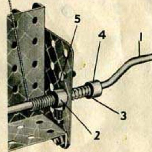
Le ressort de compression 3 est monté sur la manivelle 1 entre le collier 4 et une rondelle métallique, et maintient la bague d'arrêt 2 contre le côté intérieur de la plaque. Le collier 2 est muni d'un boulon de 9,5 mm. Si la manivelle commence à tourner, la tête de ce boulon frappe contre l'arrêt 5 et interdit le déroulement de la corde.
