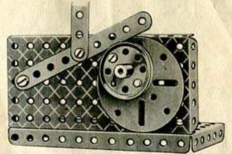
La poulie de 38 mm. est reliée à l'aide d'un écrou et d'un boulon à un plateau central. La tringle qui porte ce dernier traverse un des trous de la poulie de 38 mm. et la rend ainsi parfaitement solidaire du plateau central. Le poussoir, une bande de 9 trous, porte un bras de manivelle à son extrémité fixe; son autre extrémité s'appuie sur la gorge de la poulie de 38 mm.
