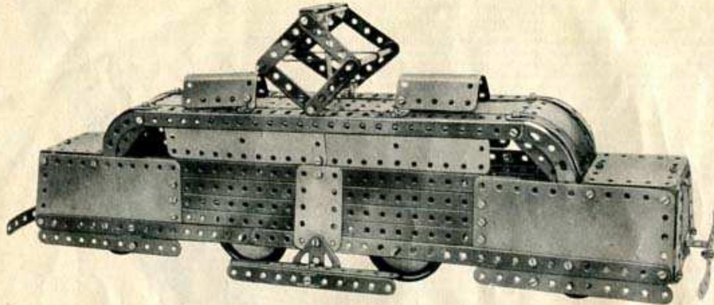
Chaque côté du modèle est formé par deux plaques flexibles de 14 x 6 cm. qui recouvrent sur trois trous les extrémités de trois bandes de 25 trous et d'une cornière de 25 trous. Les plaques flexibles sont reliées par leur bord inférieur par une bande composée de deux bandes de 25 trous qui se recouvrent sur 9 trous.
