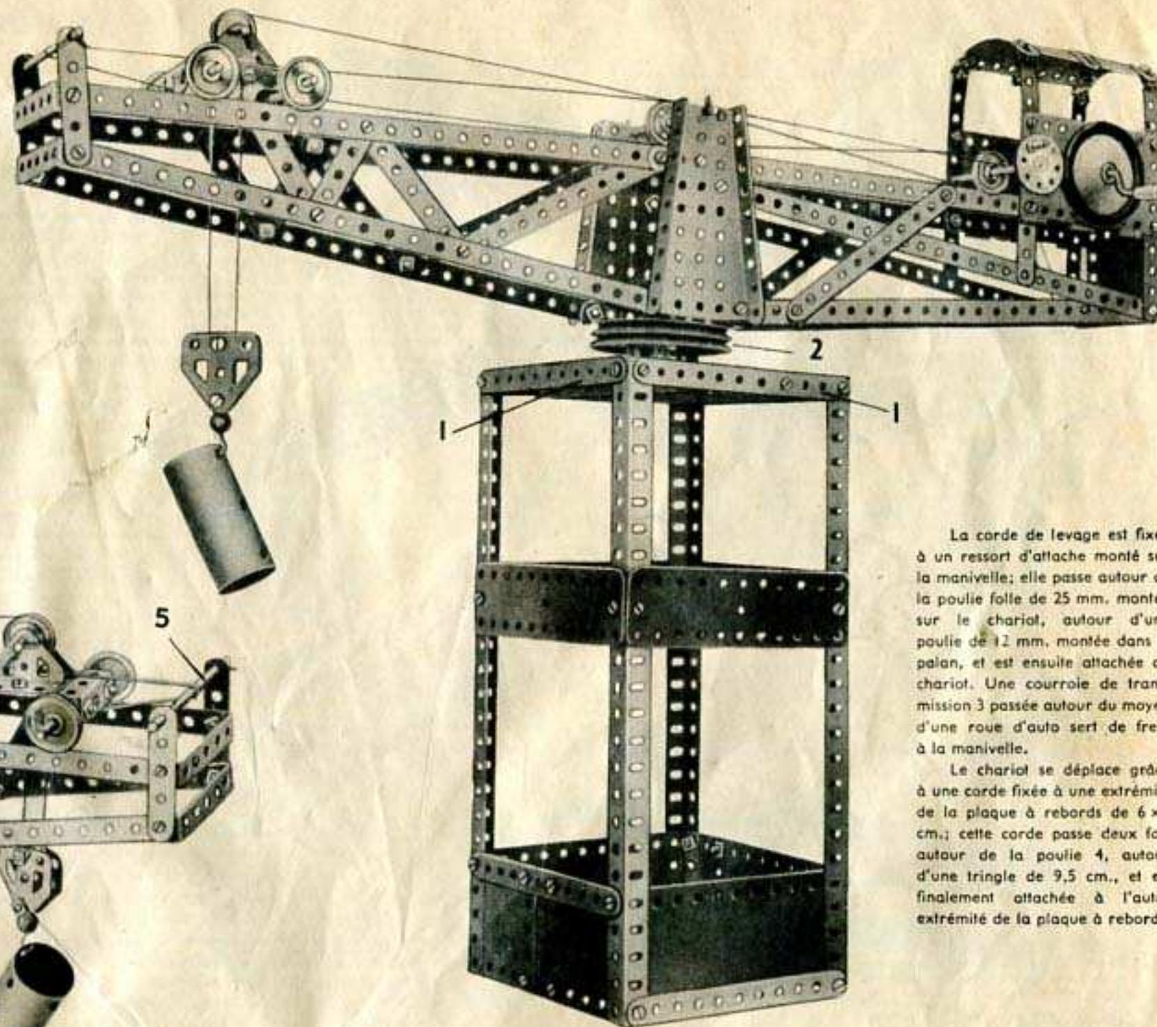
La corde de levage est fixée à un ressort d'attache monté sur la manivelle; elle passe autour de la poulie folle de 25 mm. montée sur le chariot, autour d'une poulie de 12 mm. montée dans le palan, et est ensuite attachée au chariot. Une courroie de transmission 3 passée autour du moyeu d'une roue d'auto sert de frein à la manivelle.
