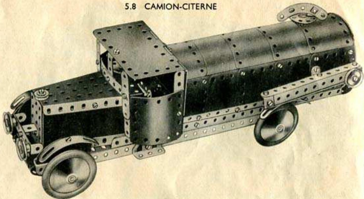
Le châssis du modèle est représenté sur la Fig. 5.8a. Chacun de ses longerons consiste en deux cornières de 32 cm. se recouvrant sur 18 trous et boulonnées l'une à l'autre. Le dessus et le dessous du capot sont formés par des plaques secteurs à rebords, et les plaques flexibles de 11,5 x 6 cm. formant les parois latérales de cette partie du modèle sont boulonnées au côté intérieur des rebords de celles-ci.
