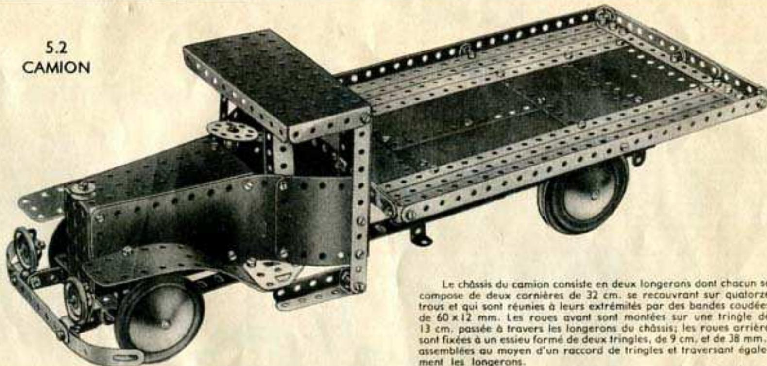
Le châssis du camion consiste en deux longerons dont chacun se compose de deux cornières de 32 cm. se recouvrant sur quatorze trous et qui sont réunies à leurs extrémités par des bandes coudées de 60 x 12 mm. Les roues avant sont montées sur une tringle de 13 cm. passée à travers les longerons du châssis; les roues arrière sont fixées à un essieu formé de deux tringles, de 9 cm. et de 38 mm., assemblées au moyen d'un raccord de tringles et traversant également les longerons.
