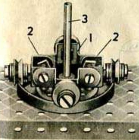
Le châssis est constitué par des cavaliers 1 reliés par deux supports doubles 2. Les quatre roues utilisées sont des poulies folles de 12 mm. qui tournent dans des boulons pivots fixés aux quatre extrémités du châssis. Quatre rondelles métalliques (2 de chaque côté des poulies) sont passées sur le corps de chaque boulon pivot fixé aux supports doubles 2. Pour les deux autres boulons pivots deux rondelles sont placées du côté extérieur de la poulie seulement.
