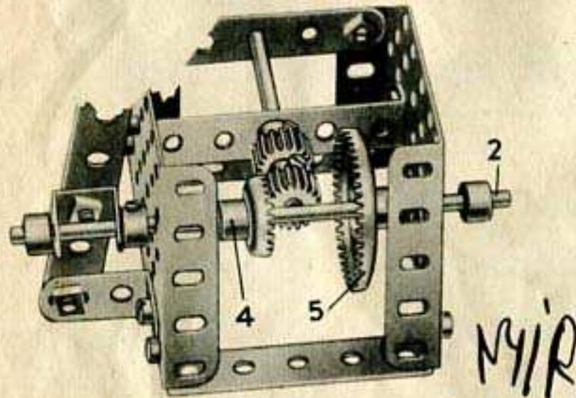
Ce mécanisme est destiné à donner une marche avant lente et une marche arrière rapide — ou vice-versa — et chacune des tringles peut être employée comme arbre moteur.
