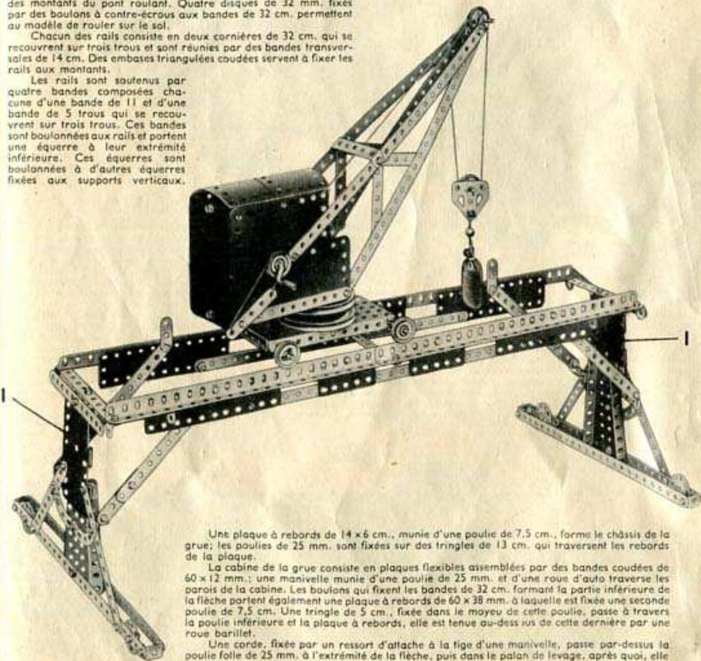
Une plaque à rebords de 14 x 6 cm., munie d'une poulie de 7,5 cm., forme le châssis de la grue; les poulies de 25 mm. sont fixées sur des tringles de 13 cm. qui traversent les rebords de la plaque.
