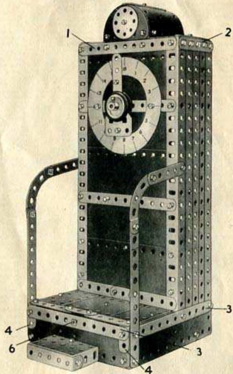
Les parois verticales sont constituées par quatre cornières de 25 trous réunies par des bandes de 11 trous 1, et des bandes de 5 trous 2. Chaque paroi est recouverte par trois bandes de 25 trous. La face avant est munie de quatre plaques flexibles de 11,5 x 6 cm., d'une plaque flexible de 6 x 6 cm. et d'une autre de 11,5 x 6 cm. qui se recouvrent sur 3 trous.
