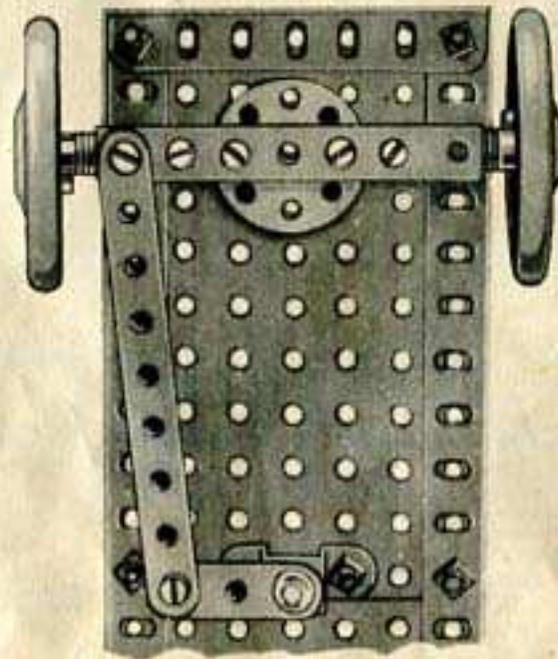
Les deux roues avant sont montées sur des fusées séparées qui sont fixées à chaque extrémité d'un essieu avant rigide.
