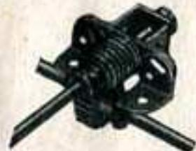
Le mécanisme d'entraînement pour essieux arrière représenté ci-dessus, est destiné principalement à être employé dans les petits modèles d'automobiles. Deux Equerres d'Angle sont fixées, par des Boulons, traversant leurs trous allongés, à une Bande de 38 mm, à laquelle est également fixé un Cavalier. La Tringle portant la Vis sans fin est passée à travers le milieu de la Bande et le Cavalier : elle est tenue par une Bague d'Arrêt.
