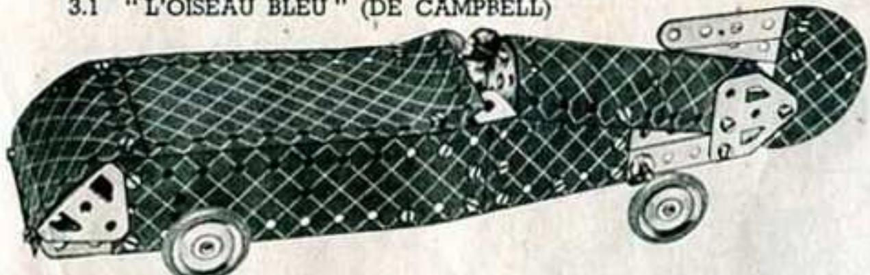
La Plaque à rebords de 14×6 cm. forme l'extrémité avant du châssis et les deux Plaques flexibles de 14×4 cm. sont boulonnées des deux côtés par le troisième trou en comptant de l'extrémité avant du châssis. Les deux Bandes de 14 cm. formant l'extrémité arrière du châssis recouvrent les Plaques flexibles de 14×4 cm. sur un trou.
