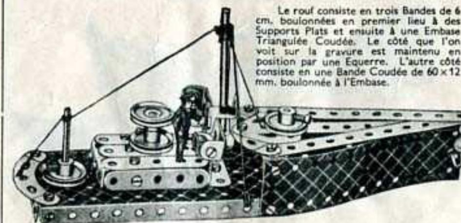
Le rouf consiste en trois Bandes de 6 cm. boulonnées en premier lieu à des Supports Plats et ensuite à une Embase Triangulaire Coudée. Le côté que l'on voit sur la gravure est maintenu en position par une Equerre. L'autre côté consiste en une Bande Coudée de 60x12 mm. boulonnée à l'Embase.
