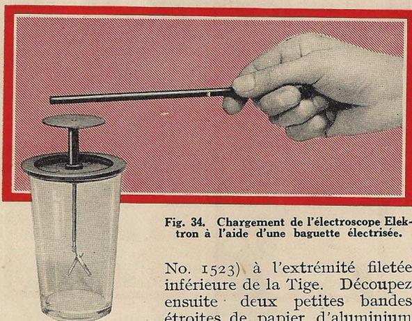
Fig. 34. Chargement de l'électroscope Elektron à l'aide d'une baguette électrisée.
