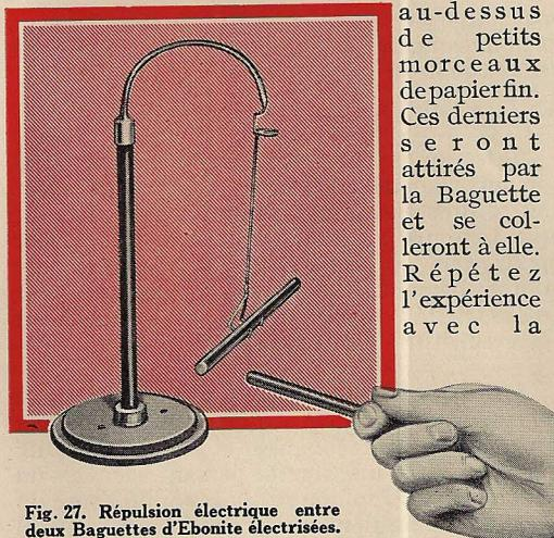
Fig. 27. Répulsion électrique entre deux Baguettes d'Ebonite électrisées.
