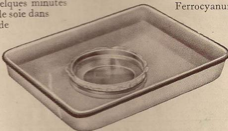
Fig. 64. Le sucre se sépare de l'amidon à la suite de la lente diffusion qui se produit à travers le parchemin.
