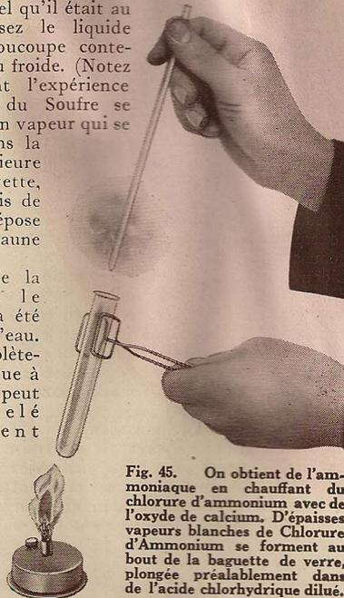
Fig. 45. On obtient de l'ammoniaque en chauffant du chlorure d'ammonium avec de l'oxyde de calcium. D'épaisses vapeurs blanches de Chlorure d'Ammonium se forment au bout de la baguette de verre, plongée préalablement dans de l'acide chlorhydrique dilué.
