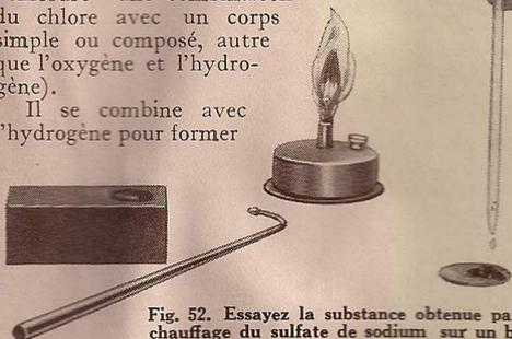
Fig. 52. Essayer la substance obtenue par le chauffage du sulfate de sodium sur un bloc de charbon de bois. Il se dégagera de l'hydrogène sulfuré.
