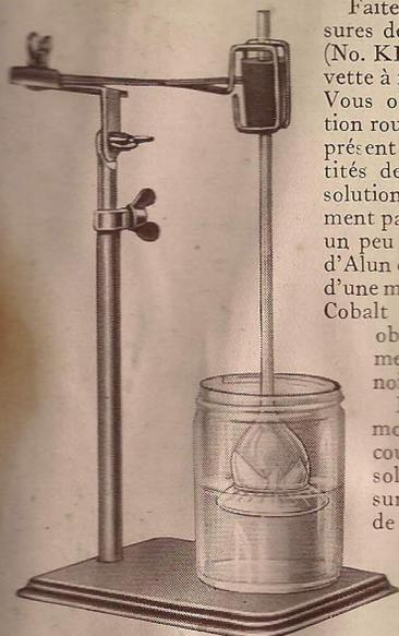
Fig. 62. Diffusion d'une solution de Sulfate de Cuivre à travers du parchemin.
