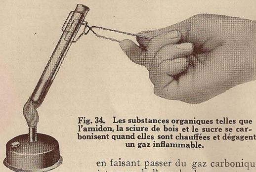
Fig. 34. Les substances organiques telles que l'amidon, la sciure de bois et le sucre se carbonisent quand elles sont chauffées et dégagent un gaz inflammable.
