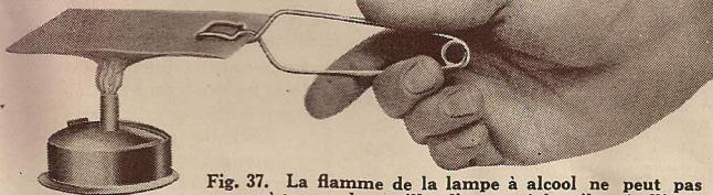
Fig. 37. La flamme de la lampe à alcool ne peut pas passer à travers les mailles d'un carré de toile métallique.
