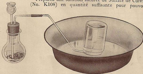
Fig. 22. L'hydrogène se dégage sous l'action de l'acide sulfurique dilué sur le Zinc et est recueilli dans un bocal. Le gaz remplace l'eau dans le récipient renversé.
