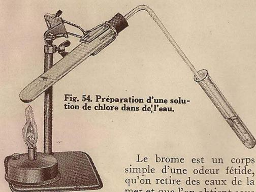
Fig. 54. Préparation d'une solution de chlore dans de l'eau.
