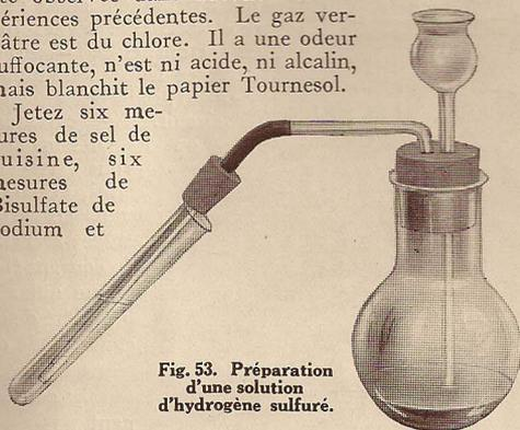
Fig. 53. Préparation d'une solution d'hydrogène sulfuré.
