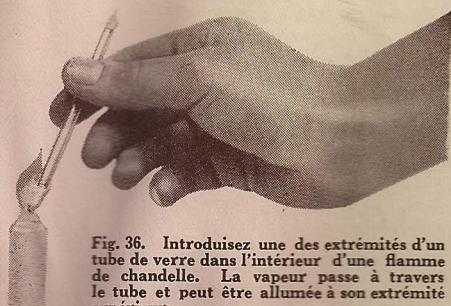
Fig. 36. Introduisez une des extrémités d'un tube de verre dans l'intérieur d'une flamme de chandelle. La vapeur passe à travers le tube et peut être allumée à son extrémité supérieure.
