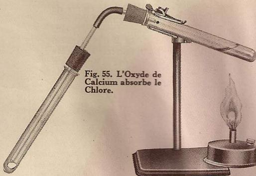
Fig. 55. L'Oxyde de Calcium absorbe le Chlore.
