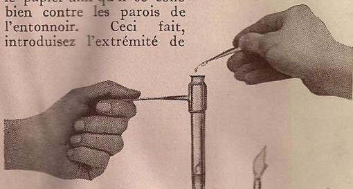
Fig. 14. Introduisez du Charbon de Bois dans une éprouvette contenant du Nitrate de Potassium fondu. Le Charbon de Bois prend feu.
