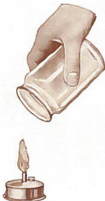
Fig. 14. — La flamme s'éteint au contact du gaz carbonique.
