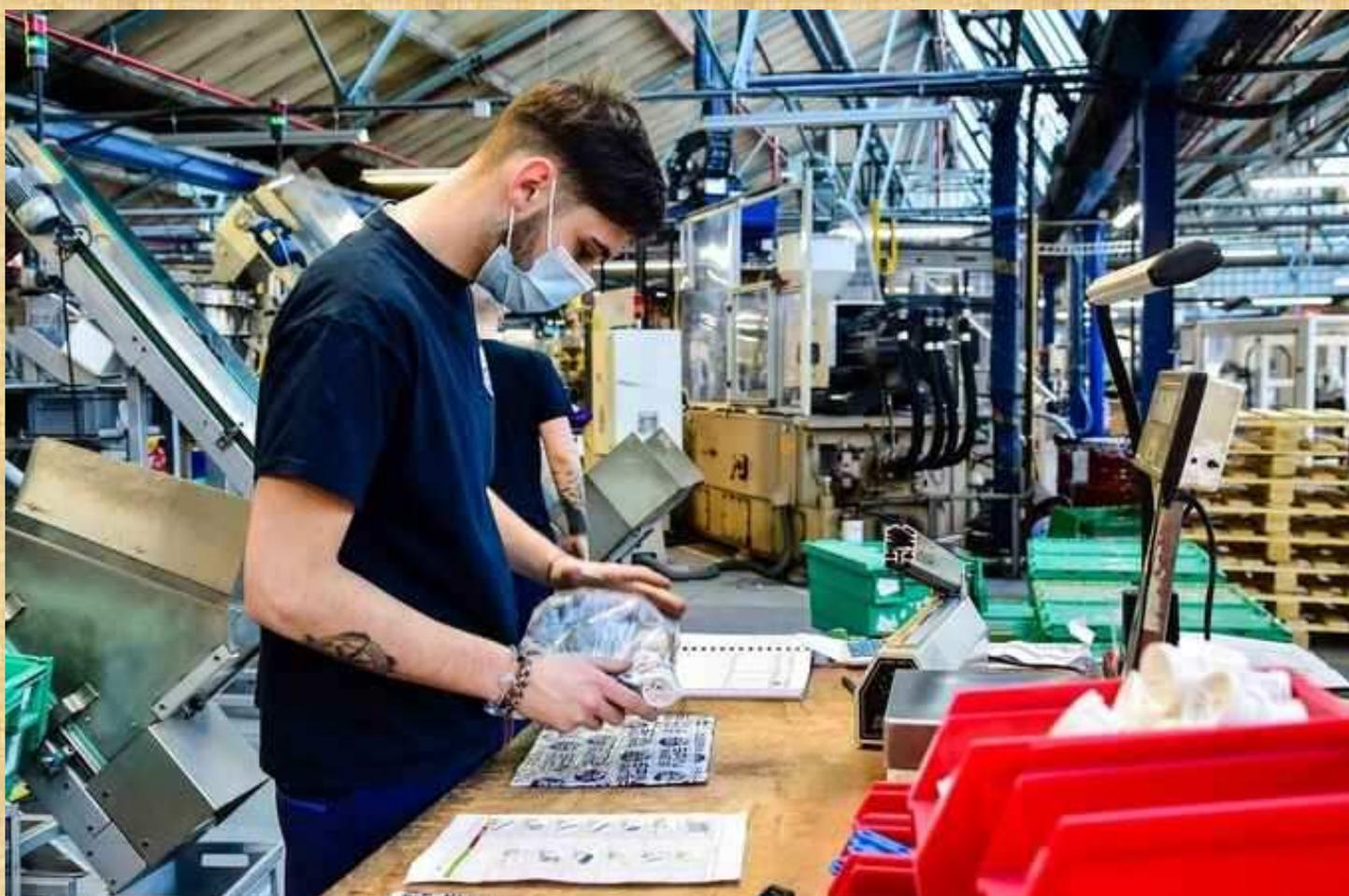
Chaque sachet de pièces est pesé automatiquement afin d'être vérifié. En cas de souci, un opérateur rajoute les éléments manquants. (Photo : Gautier Demouveaux)
