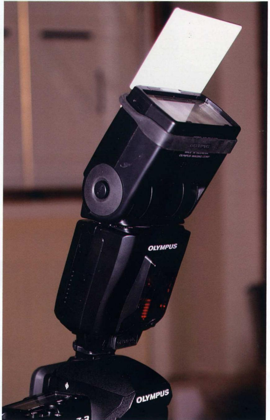
Figure 5 : Le réflecteur est un simple rectangle de plastic blanc, qui renvoie une partie de la lumière du flash indirect directement vers le sujet et favorise un meilleur contraste
