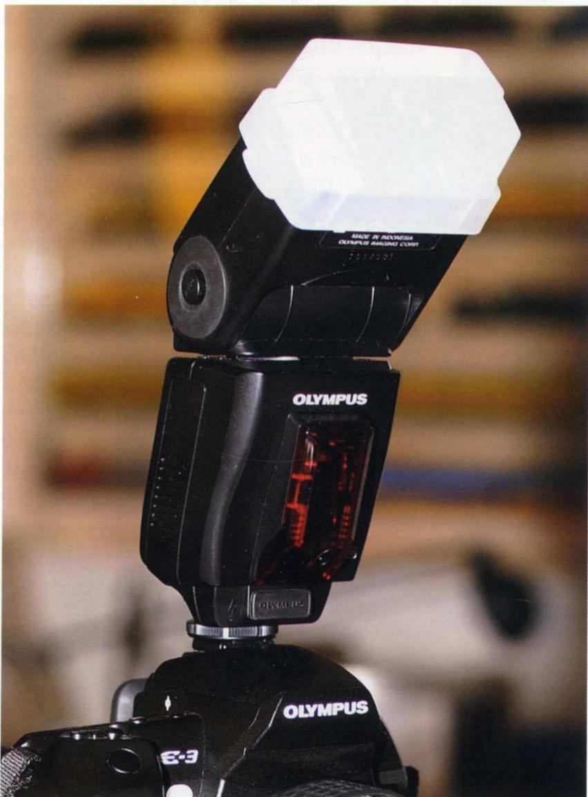
Figure 4 : Le diffuseur est une petite boîte translucide qui se monte simplement sur la tête du Flash.
